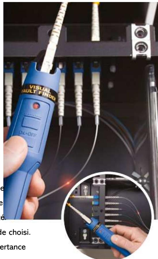
Le VFF5 est un testeur de défauts optiques, émettant un signal laser rouge visible à 650nm. L'utilisateur pourra voir une fuite de lumière au niveau de la gaine abîmée inférieure à 3mm de diamètre ou à l'extrémité du lien testé. Un mode continu ou pulsé facilite les recherches et la LED indique le mode choisi. Le bouton de mise en route est protégé pour éviter de l'allumer par inadvertance
